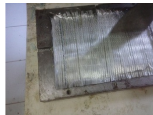
Figura 2: Molde em aço para confecção do compósito, com cera de carnaúba, aplicação da resina e impregnação dos reforços
