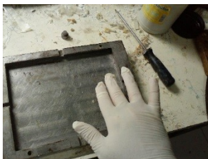
Figura 2: Molde em aço para confecção do compósito, com cera de carnaúba, aplicação da resina e impregnação dos reforços
