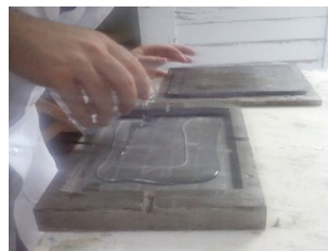
Figura 2: Molde em aço para confecção do compósito, com cera de carnaúba, aplicação da resina e impregnação dos reforços
