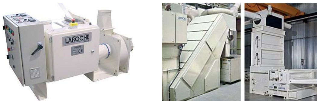
Figura 2. (a) Máquina Minitrim utilizada para uniformização dos retalhos e (b) desfibreadora Jumbo, ambas da empresa francesa Laroche (Laroche, 2014)
